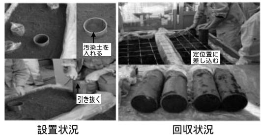
第2図 汚染土・温度計の設置状況及び消毒装置の配置
