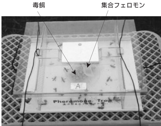
第1図 集合フェロモンと毒餌を内部に設置した乾式トラップ （毒餌：エトフェンブロックス乳剤100倍希釈液に浸漬したダイズ子実）
